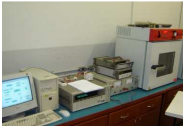
Figura 2.2: Câmara de vácuo usada para garantir isolamento térmico nas superfícies sem contato entre amostra e aquecedor e expostas ao meio externo.
