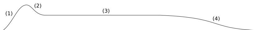
Figura 4.14: Partes de um envelope de onda: (1) Ataque, (2) decaimento inicial, (3) sustentação e (4) decaimento final.
