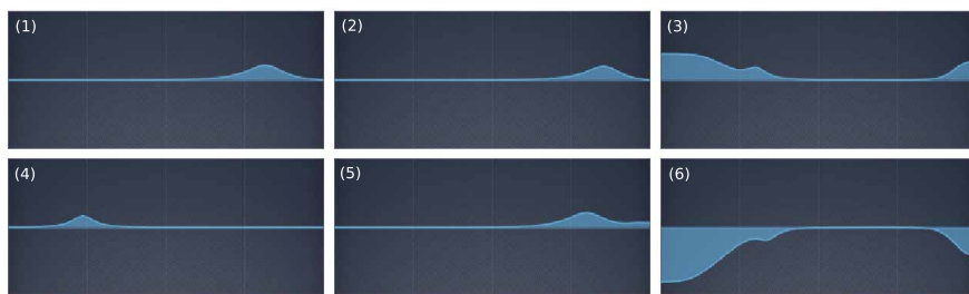
Figura 4.17: Curvas de resposta de frequência para os filtros (1) Add Brightness , (2) Add Sharpness , (3) Bass Boost , (4) Stronger Bass , (5) Vocal Presence e (6) Telephone Voice .
