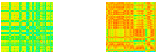
Figura 4.10: Matrizes de auto-similaridade correspondentes aos descritores de cromia e de amplitude, respectivamente, para o áudio da música Anything Goes, da banda AC/DC. A escala de cores vai do azul (baixa similaridade) para o vermelho.
