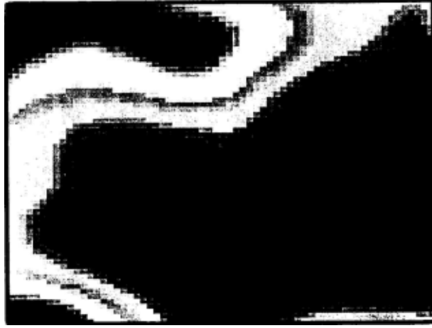
Figura 4.9: Campo de permeabilidade bi-dimensional gerado por uma distribuição Browniana com H=0,89 . Áreas mais escuras e mais claras representam as regiões menos e mais permeáveis, respectivamente.
