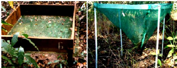
**Figura 1.** Modelos de coletores de serrapilheira produzida: (A) coletor quadrado (VALENTINI, 2004) e (B) coletor cônico (VALENTINI et al., 2014)
